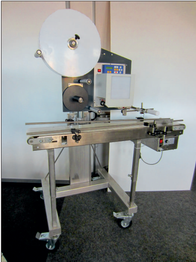
Etikettierstation mit Spender, Drucker und Förderband
