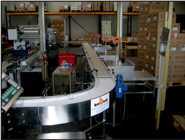
Wiegeeinrichtungen zum Kontrollwiegen mit Förderband und Kurvenband sowie automatischen Einzug in eine Floatpack Anlage.
