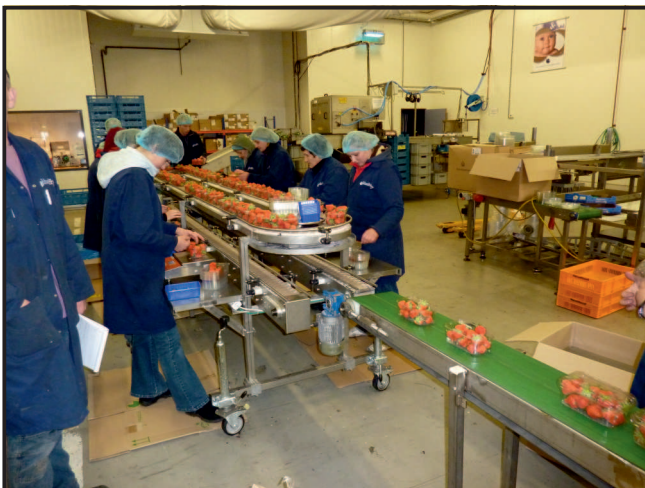
Kontroll und Sortieranlage mit Übergabeband. Alle Waagen mit PC - Anbindung. Check and sorting facility with hand-over transmission belt. All weighing machines PC connected.
