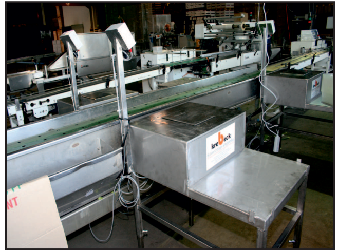
Wiegeeinrichtungen im Tisch eingebaut. Absatz für Kistenaufnahme 600 x 400 mm im Gestell.
